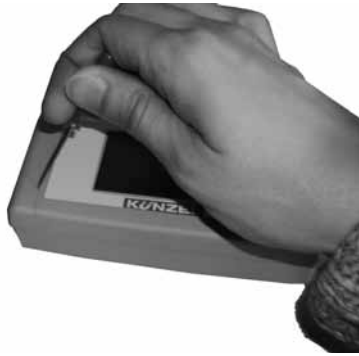
Abb. 2: Nehmen Sie die Seitenverkleidung des Gehäuses mithilfe eines kleinen Schraubenziehers o.ä. ab.
