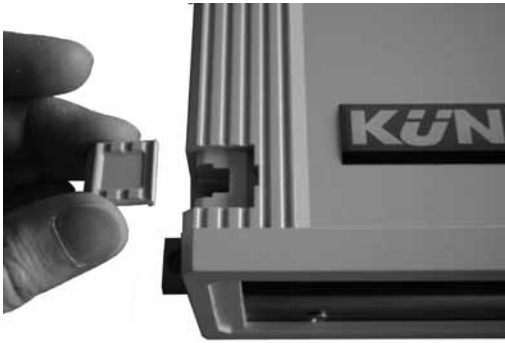
Abb. 6: Entfernen der Clips in der Abdeckung
